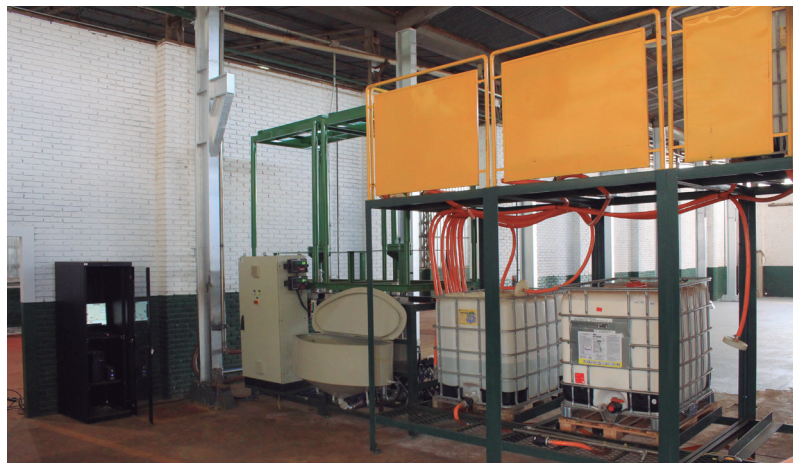
"Smart Calda", equipamento de dosagem automática dos produtos de preparo da calda
