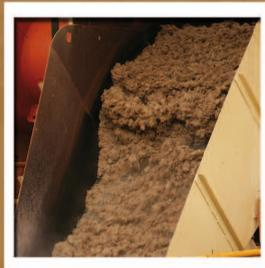
A cana passa pelo desfibrador. A função deste equipamento é completar o preparo da cana para, também, retirar a máxima extração possível de sacarose. Na foto acima, a cana já está desfibrada.
