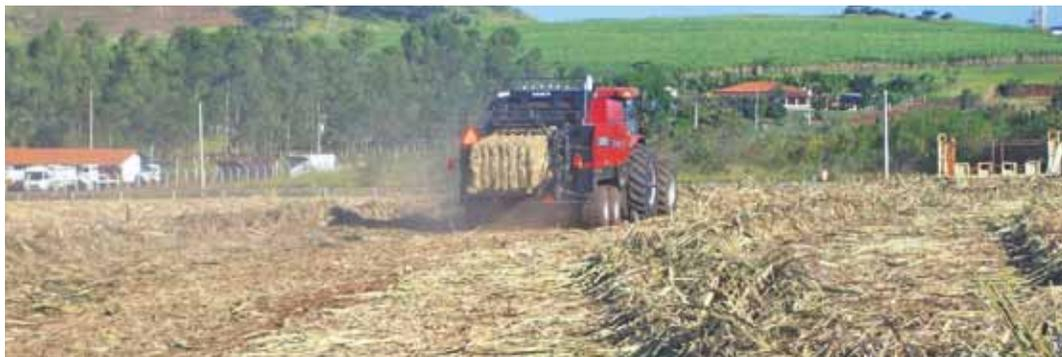
Máquina recolhe e compacta em fardos palha transportada para a Indústria
