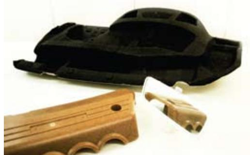
Painéis, retrovisor e tampa para motor de carros são desenvolvidos com o PHB
